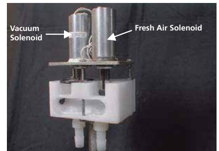
CoPulsation™ hat zwei Ventile! Das eine Ventil sorgt für Vakuum im Pulsraum, das andere für Atmosphärendruck. Beide Ventile öffnen abwechselnd, 30 Millisekunden vergehen zwischen dem Schließen des einen und dem Öffnen des anderen Ventils. So werden Luft und Vakuum nicht vermischt.
